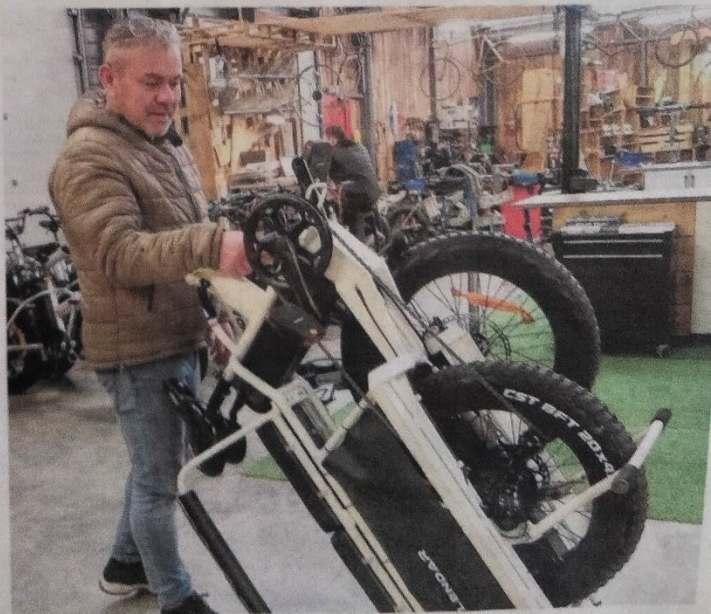
Une fois plié, le longtail se transporte sur ses roulettes, comme une grosse valise (Photos Paris-Normande et collection privée)
